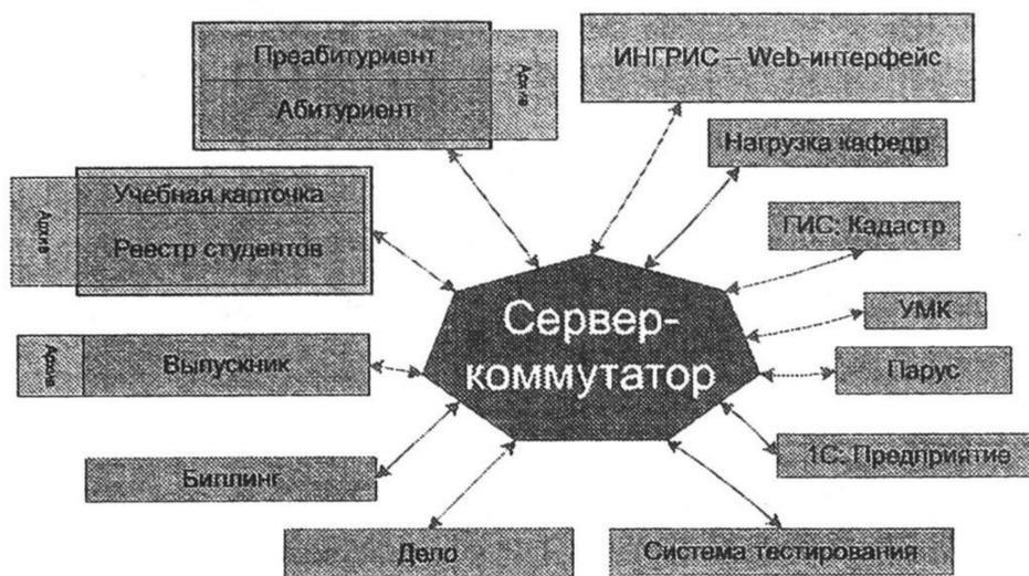
Рис. 4. Схема потоков данных при использовании специального сервера-коммутатора ИНГРИС
