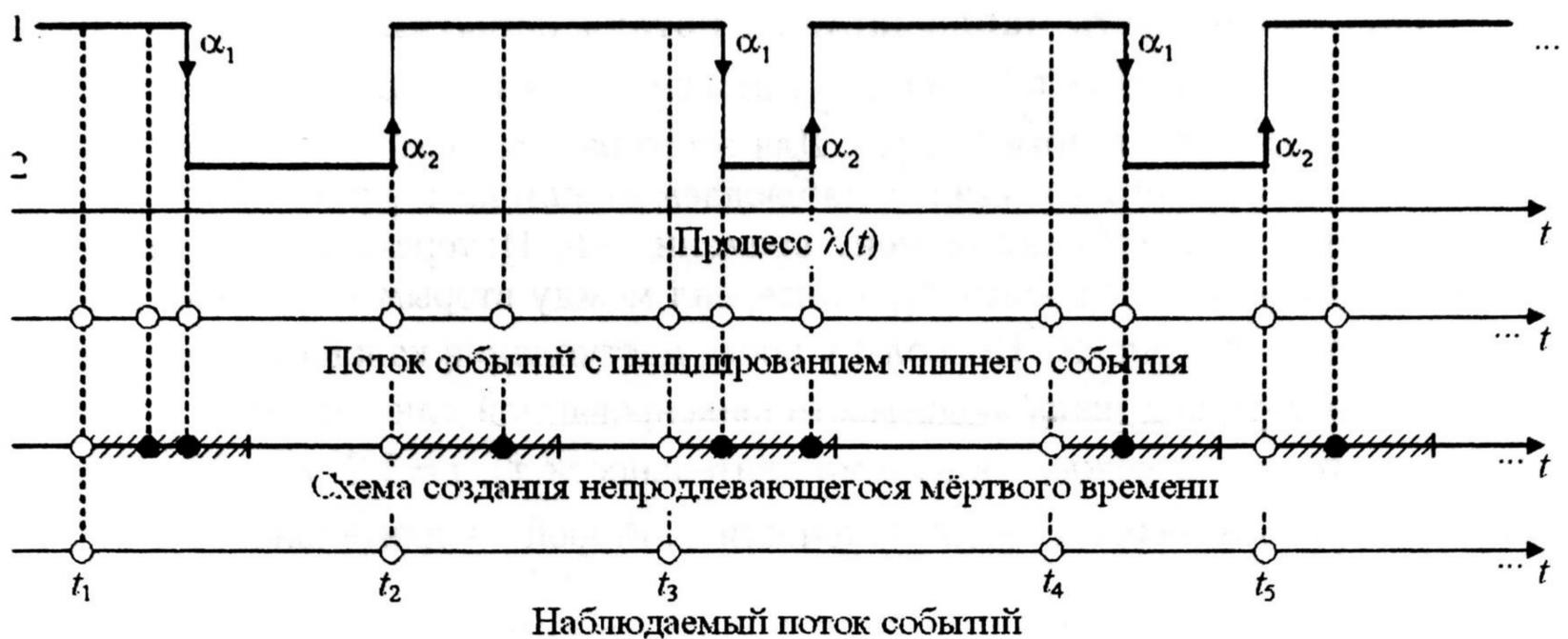
Рис. 1. Формирование наблюдаемого потока событий в схеме с непродлевающимся мертвым временем: 1,2 — состояния случайного процесса; штриховка — периоды мертвого времени;  $t_1, t_2, \dots$  — моменты наступления событий в наблюдаемом потоке.
