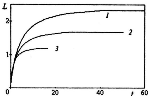
Рис. 3. Зависимость безразмерной длины трещины  $L$  от безразмерного времени  $t$ ; кривые 1, 2, 3 — соответствуют объемному содержанию частиц в смеси  $\alpha = 0.05, 0.1, 0.2$ ; конечные точки кривых 2 и 3 показывают момент заполнения пропантом всей трещины, для кривой 1 он равен  $\approx 200$
