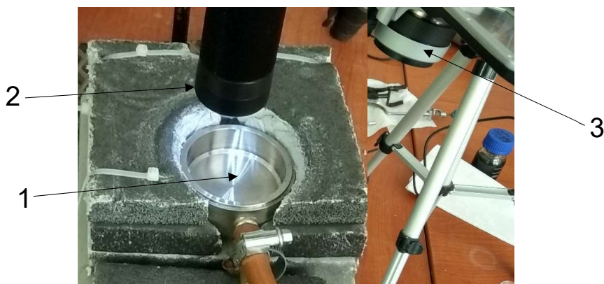
Рис. 1. Фотография экспериментальной установки: 1 — теплоизолированная чаша, соединенная с жидкостным термостатом; 2 — видеомикроскоп UCMOS05100KPA; 3 — тепловизионная камера FLIR X6400sc
