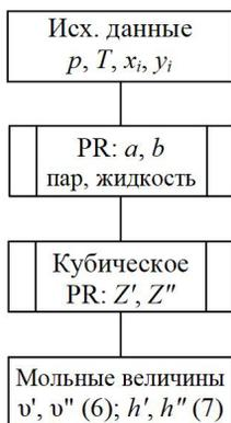
Рис. 2. Блок-схема расчета термодинамических параметров (ТД)
