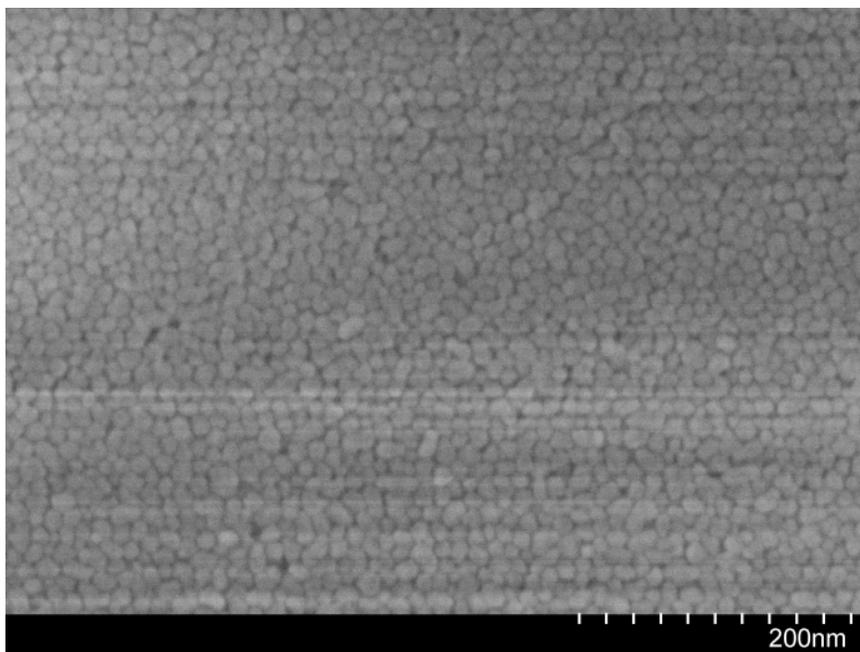
**Рис. 4.** Электронная микрофотография сuspензии наночастиц 1030 при увеличении 200 крат
