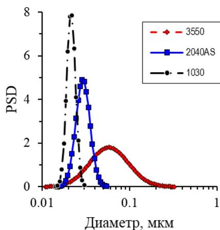
Рис. 5. Распределение частиц по размерам в суспензиях
