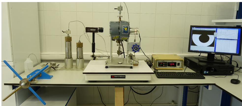
**Рис. 1.** Автоматический тензиометр IFT-820-P
