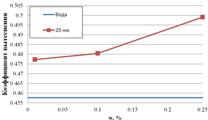
**Рис. 7.** Коэффициент вытеснения нефти из ядра водой и наносuspензией (20 нм) с разными концентрациями
