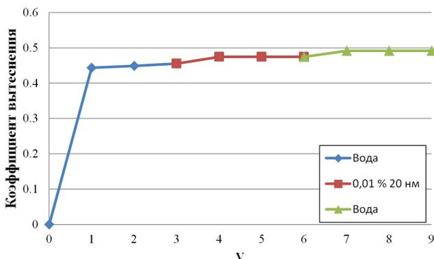
**Рис. 6.** Коэффициент вытеснения нефти из ядра базовым агентом вытеснения (вода), наносuspензией ( $\text{SiO}_2$  20 нм, 0,01%<sub>масс</sub>) и довытеснения базовым агентом в зависимости от количества поровых объемов прокачанной жидкости
