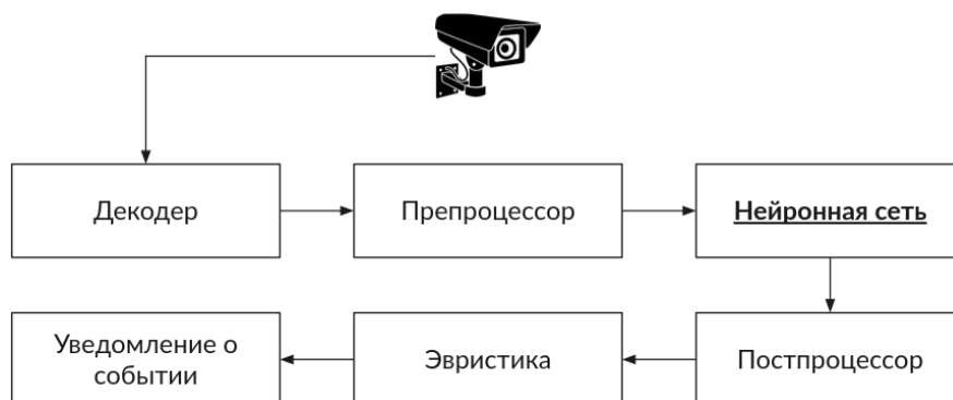
Рис. 1. Типовое устройство конвейера ВА
