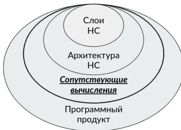
Рис. 2. Уровни ВА, из которых складывается общая производительность системы ВА
