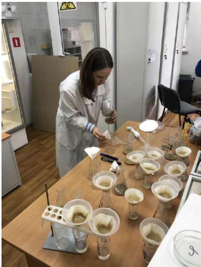
Рис. 6. Фильтрование суспензии (фото Соромотина А.В.)
