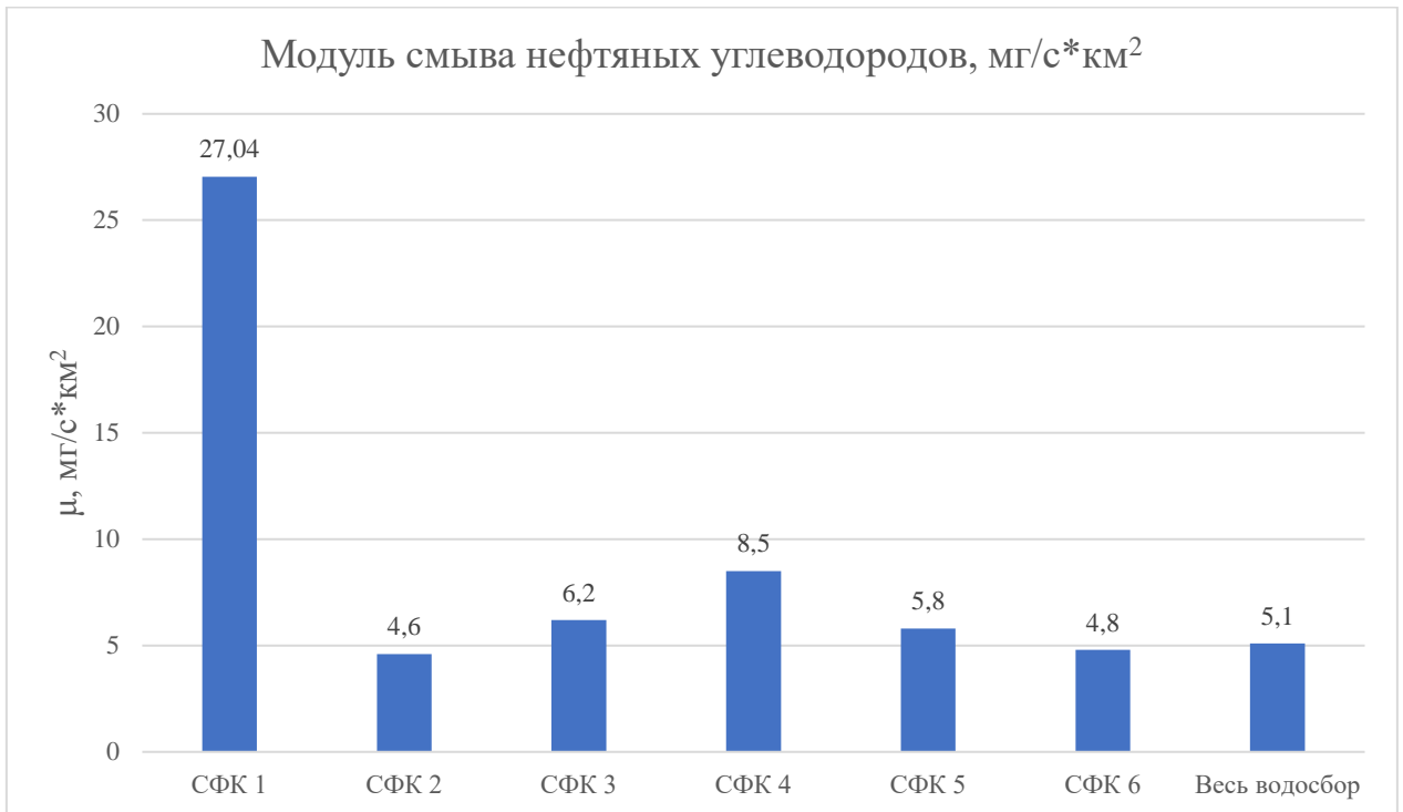
Рис. 6. Модуль смыва нефтяных углеводородов со стокоформирующих комплексов водосбора р. Моховая [составлено автором]
