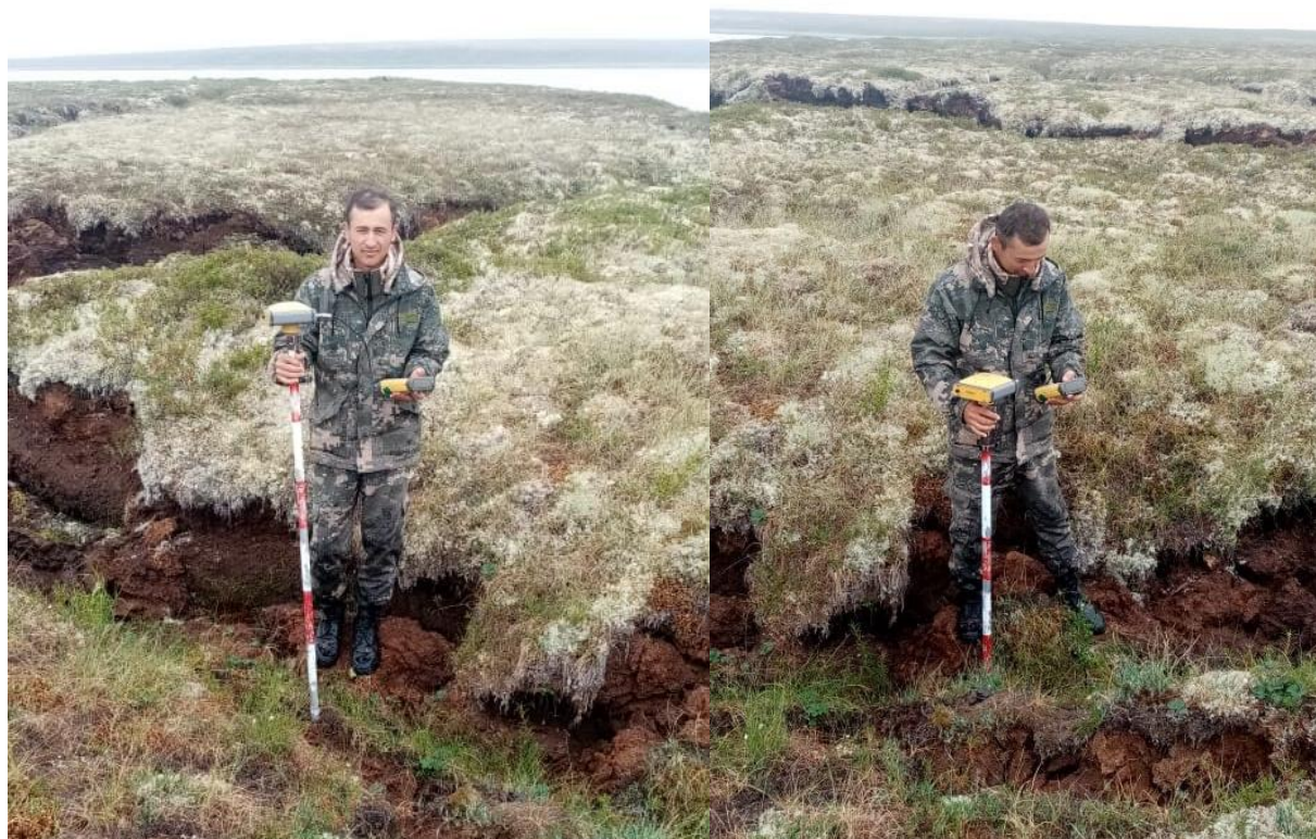
Рис. 24. Процесс съемки с использованием геодезический прибор GPS Glonass Topcon Hiper L2
