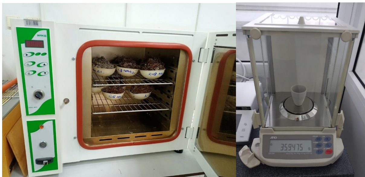
Рис. 9. Сушильный шкаф с образцами биомассы (1) и аналитические весы с прокаленным тиглем (2) (фото сделано автором)
