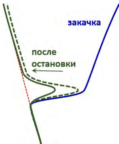
Рис. 5.8.4. Кривые термометрии в газонагнетательных скважинах: в режиме закачки и после прекращения закачки газа
