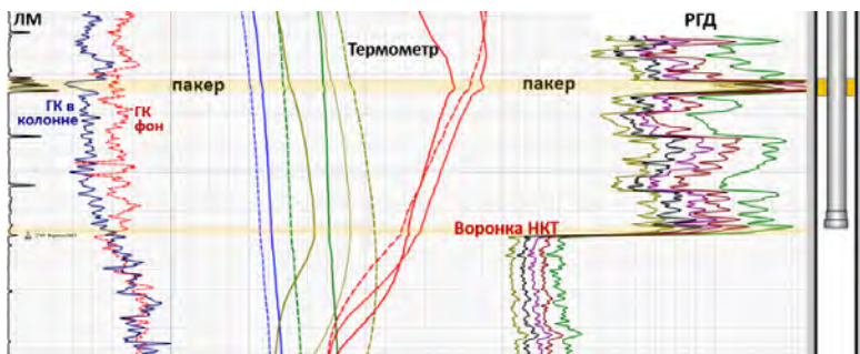
Рис. 7.1.2. Определение глубины спуска воронки НКТ и места установки пакера по ЛМ, РГД и ГК
