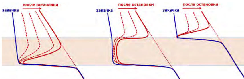
Рис. 5.8.2. Кривые термометрии после закачки: слева — приемистость только в подошве; посередине — по всей толщине; справа — только в кроне
