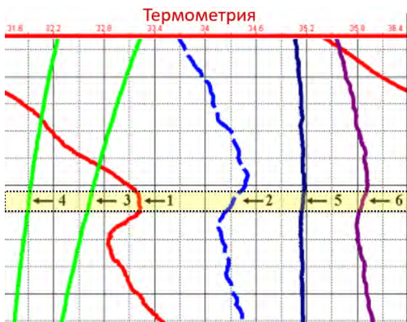
Рис. 7.5.3. Определение негерметичности НКТ по методике временной фильтрации: 1 — фоновый замер; 2 — замер после кратковременной остановки; 3, 4 — замеры под закачкой через НКТ; 5 — замер сразу после прекращения закачки; 6 — замер через 8 минут после прекращения закачки
