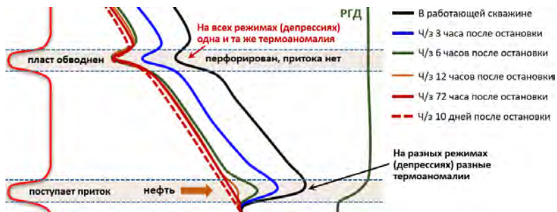
Рис. 5.5.1. Кривые термометрии после остановки скважины
