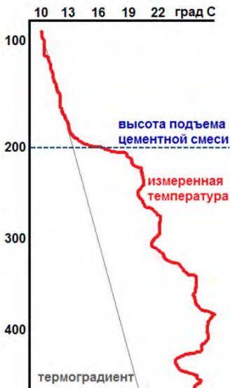
Рис. 1.6.1. Определение высоты подъема цементной смеси и зацементированных интервалов по термометрии
