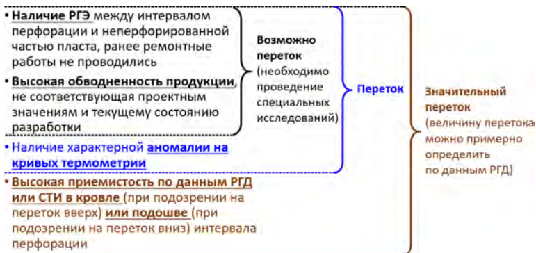
Рис. 6.2.8. Схема определения перетоков при наличии РГЭ
