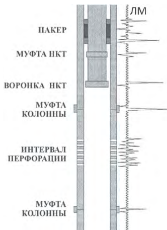
Рис. 7.1.1. Применение кривой ЛМ для определения интервалов муфтовых соединений эксплуатационной колонны и НКТ, воронки НКТ, интервалов перфорации, пакера
