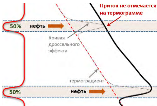
Рис. 5.4.4. Отсутствие термоаномалии на кривой термометрии из верхнего интервала при стационарном режиме исследований
