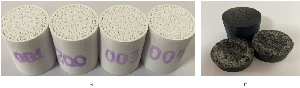
Рис. 2. Образцы искусственных кернов, полученных при 3D-печати (а); поперечный скол одного из образцов искусственных кернов (б) Fig. 2. Samples of synthetic drill cores obtained by 3D printing (a); cross chipping of one of the samples of synthetic drill cores (б)
