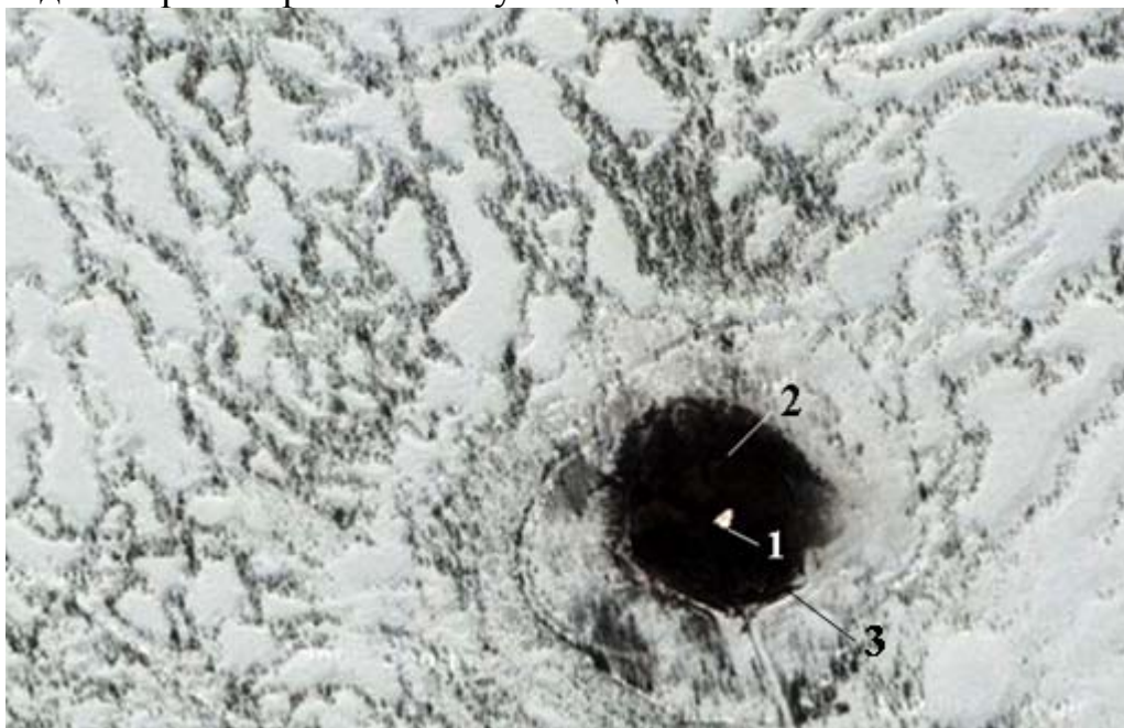
Рис. 5 - Прифакельная геотехническая система на территории Самотлорского месторождения. На космическом снимке (Quick Bird, март 2009) отчетливо дифференцируются: 1- факельные установки для сжигания попутного газа, 2 – пирогенно-нефтяные бедленды, 3 – периферическая снеговая обваловка
