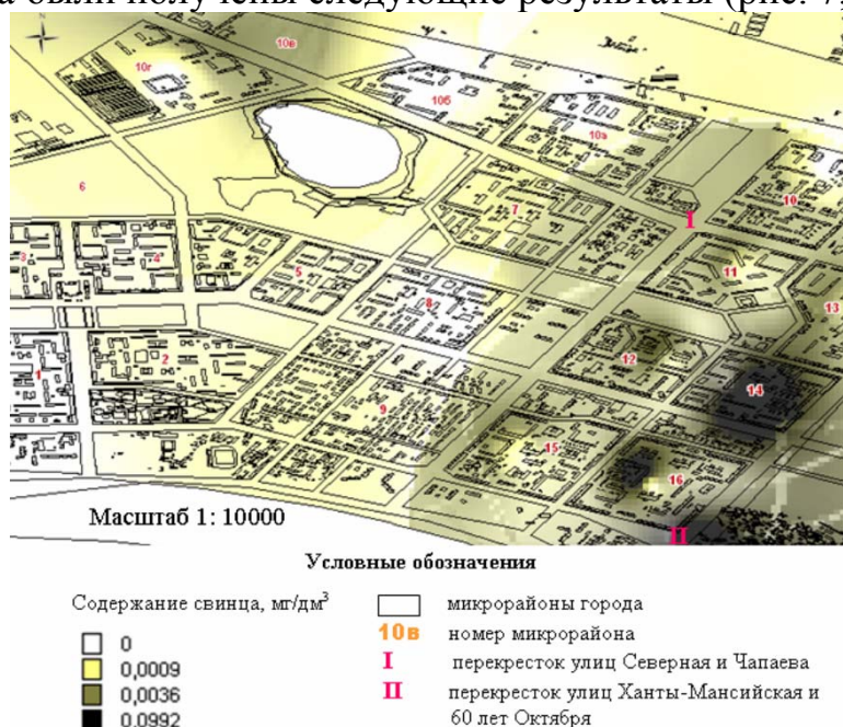
Рис. 7. Карта-схема распределения свинца в снежном покрове на территории г. Нижневартовска
