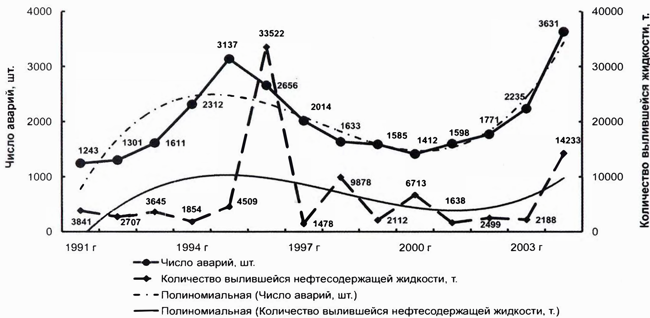
Рис.2. Динамика аварийности нефтесборных коллекторов в ХМАО-Югре
