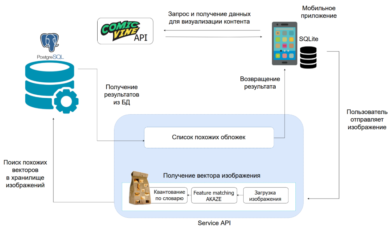
Рисунок 28. Архитектура разрабатываемой системы поиска
