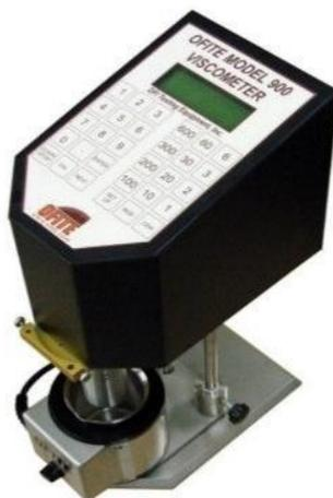
Рис 2.3. Ротационный вискозиметр OFITE 900.
