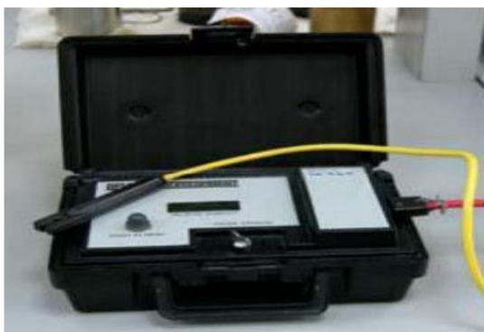
Рис 2.2. Прибор для определения электростабильности OFITE 131-50.
