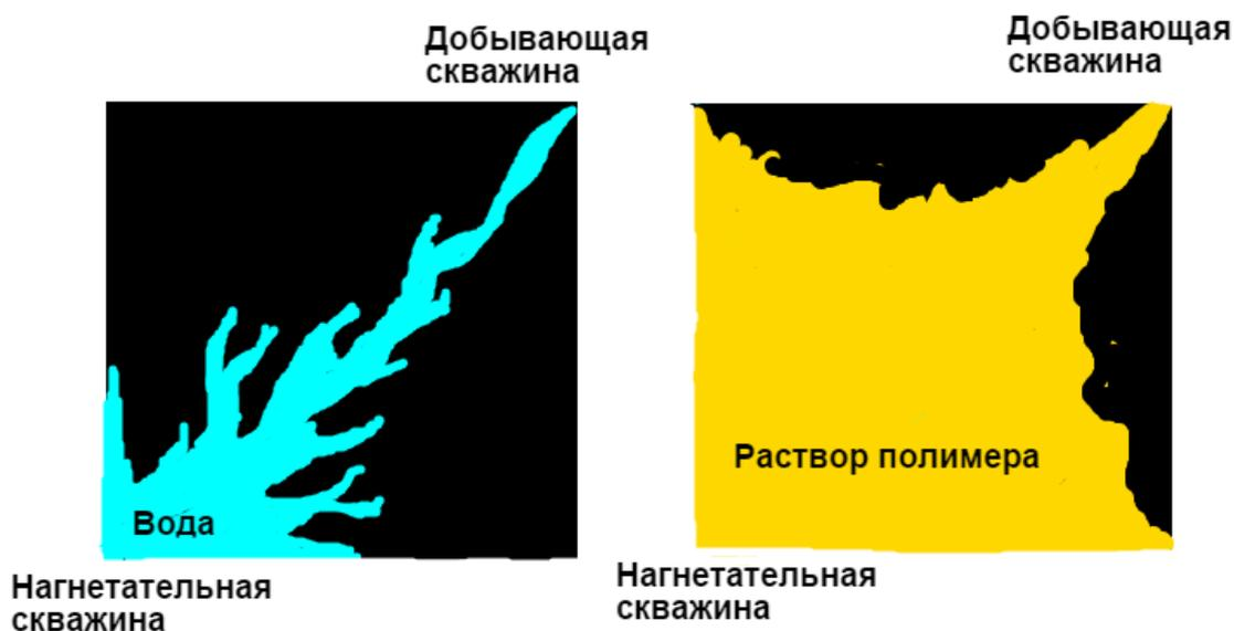
Рисунок 1.5 - Повышение области охвата при закачке раствора полимера в качестве вытесняющего реагента
