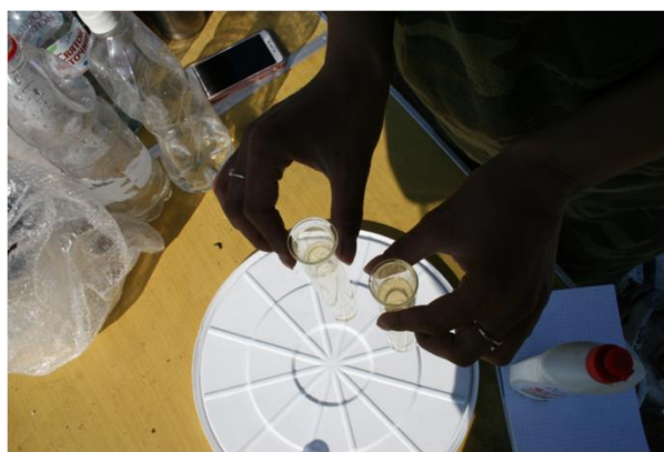
Фото 4,5. Определение цветности по кобальт-хромовой шкале (РД 52.24.497-2005) в полевых условиях (фото сделано автором)
