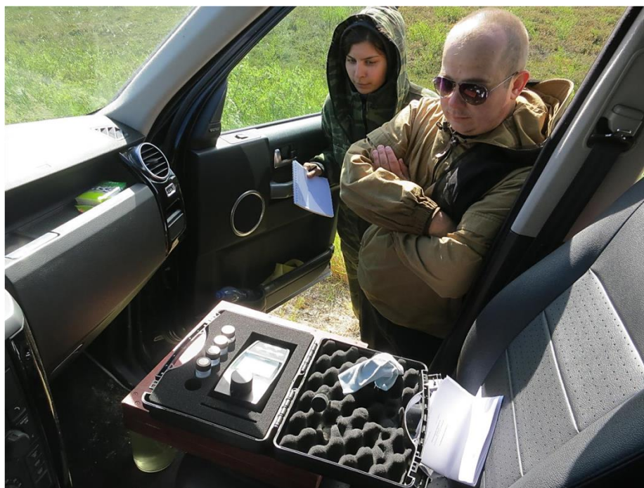
Фото 6. Определение мутности воды, в мг/дм 3 по каолину с помощью анализатора AMT 27 фирмы Amstat USA Inc (фото сделано автором)
