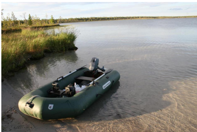
Фото 2. Резиновая лодка с мотором Yamaha 2, оснащенная эхолотом Garmin EchoMAP 42CV с GPS навигатором (фото сделано автором)
