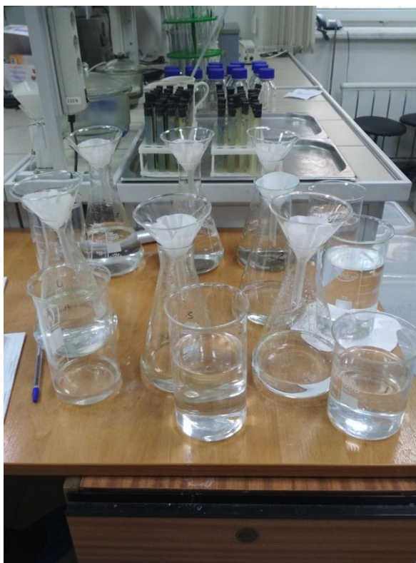
Фото 7. Фильтрация снежных проб в химической лаборатории (фото сделано автором)
