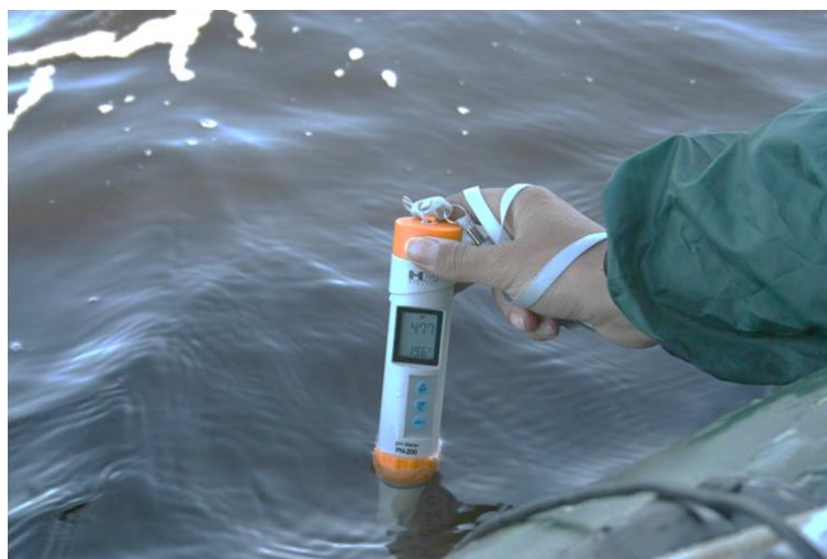
Фото 3. Измерение водородного показателя, с помощью рН метра (PH-200) на озере 1-2 (фото сделано автором)
