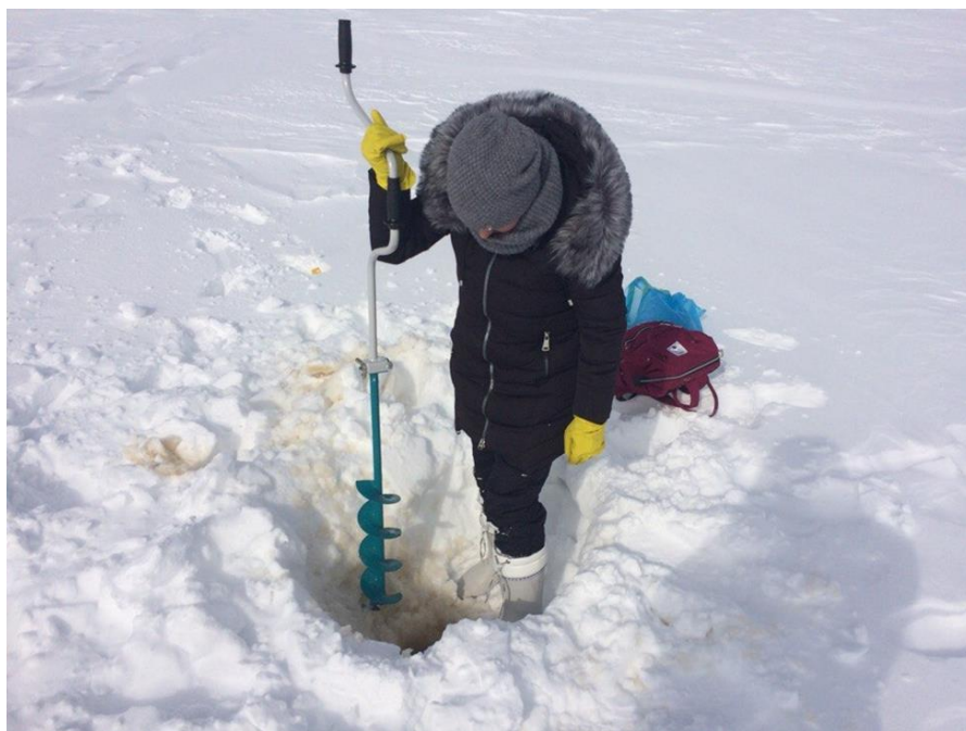
Фото 8. Отбор проб поверхностных вод ручным кольцевым буром (фото сделано автором)
