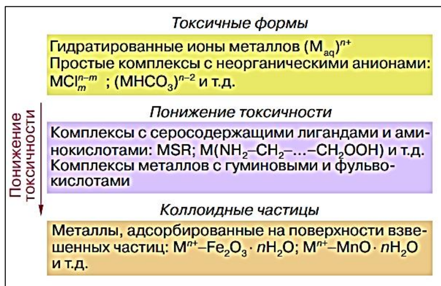
Рис. 1.7. Формы тяжелых металлов в природных поверхностных водах
