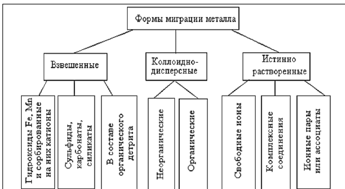
Рис. 1.5. Классификация форм миграции тяжелых металлов в водной экосистеме
