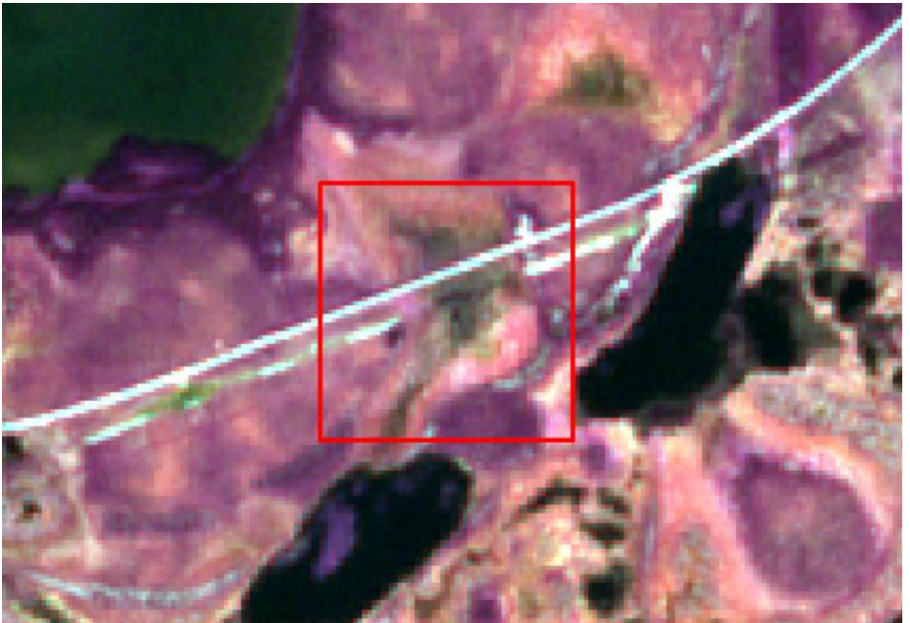
Рисунок 4. Обнаружение участков, загрязнённых нефтепродуктами (синтез каналов 8-4-3, Sentinel-2, 2016 г.)
