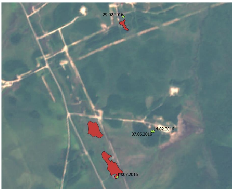
Рисунок 15. Дешифрованные участки с нефтяным загрязнением (Снимок Sentinel-2 синтез каналов 4-3-2)
