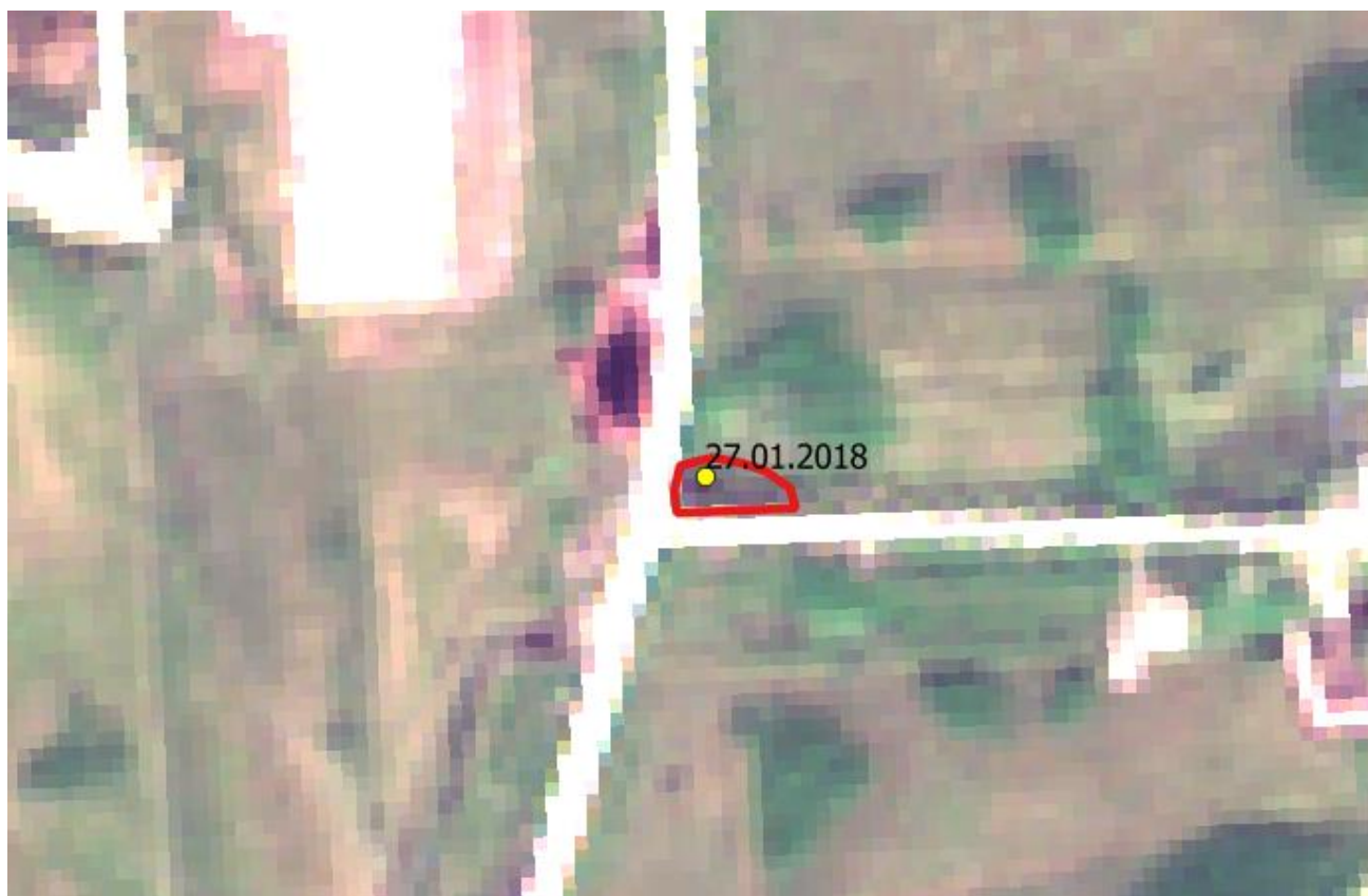
Рисунок 5. Обнаружение участков, загрязнённых нефтепродуктами (синтез каналов 4-3-2, Sentinel-2, 2018 г.)
