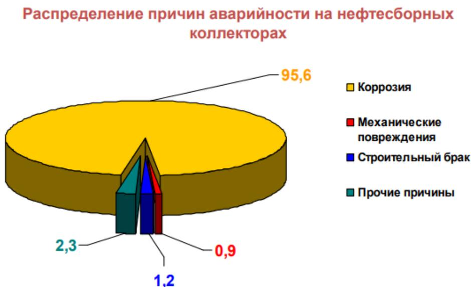
Рисунок 2 – Распределение причин аварийности на нефтесборных коллекторах (автор Соромотин А.В.)
