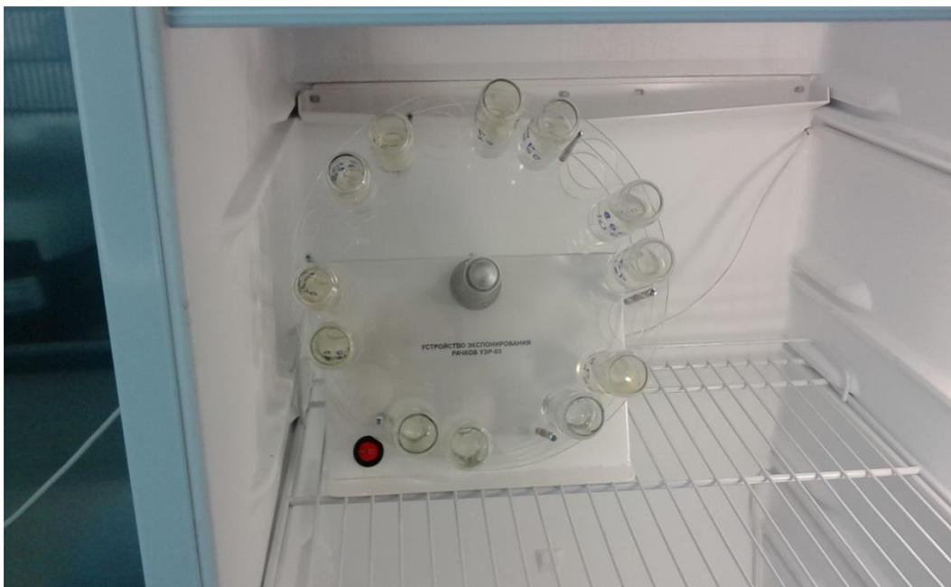
Рисунок 10- Устройство для экспонирования рачков (Автор: Усманова Д.А., 2018 г.)
