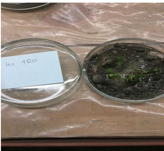
Рисунок 9- Всхожесть семян клевера в суспензии бурового шлама с дистиллированной водой (Автор: Усманова Д.А., 2018 г.)
