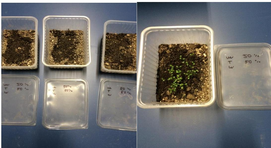
Рисунок 2- Смесь торфа и бурового шлама 50/50 (Автор: Усманова Д.А., 2018 г.)
