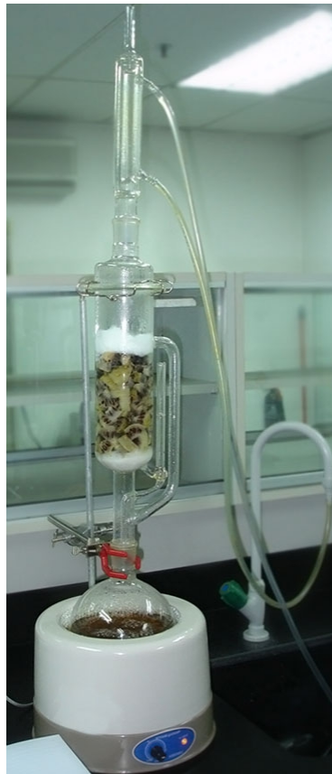
Рисунок 3. Установка для экстракции бетулина
