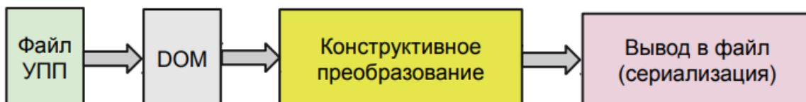
Алгоритм преобразования в CFG
