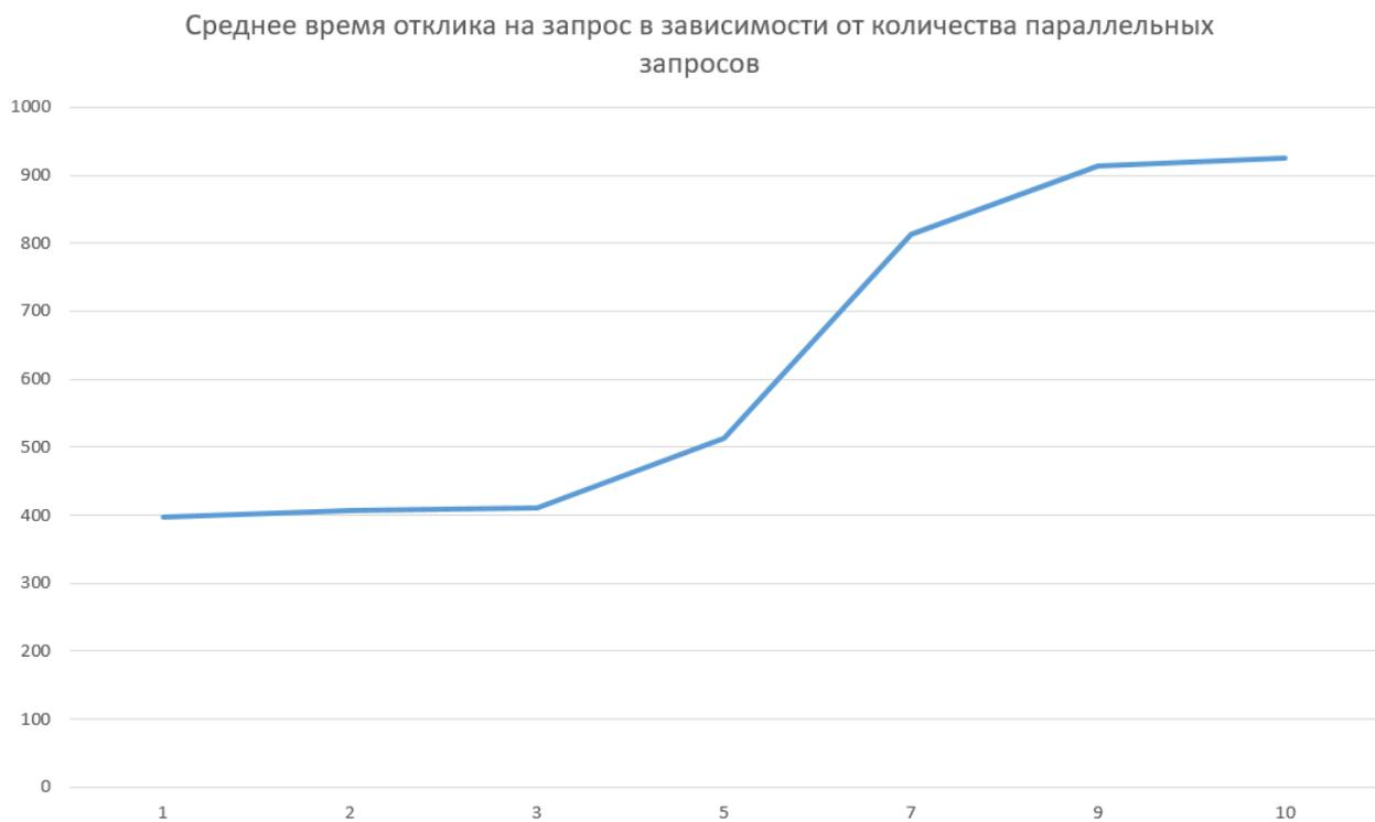
*Рисунок 25 Среднее время отклика на запрос в зависимости от количества параллельных запросов*
