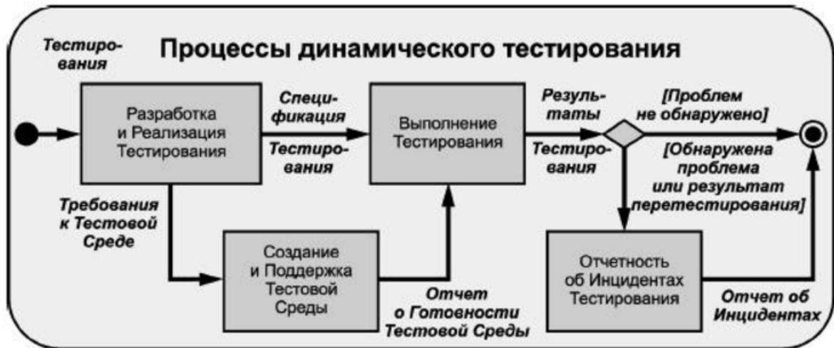
Рисунок 17 Схема процессов динамического тестирования
