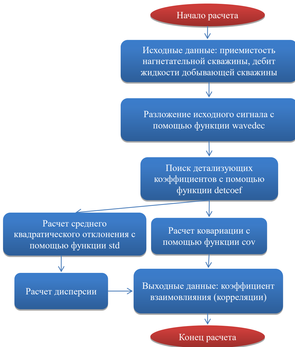
Рис.19. Блок-схема расчета коэффициентов взаимовлияния методом вейвлет-анализа в программной среде Matlab
