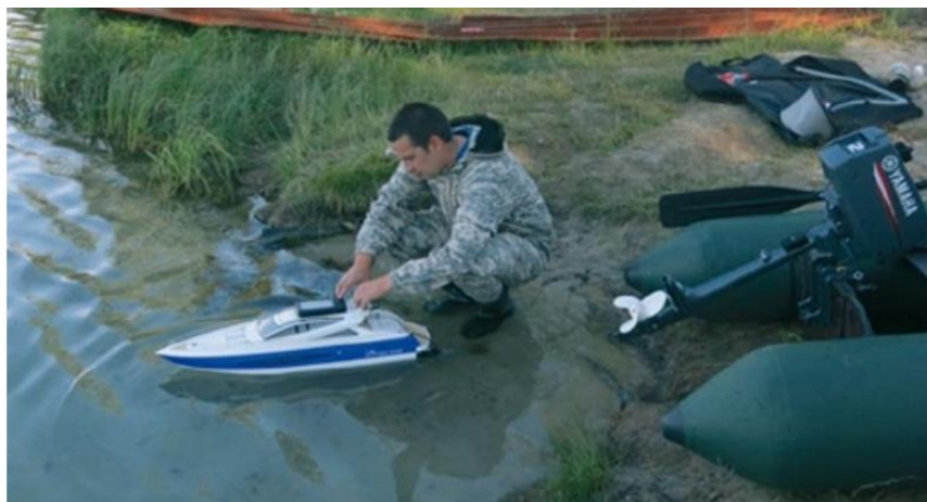
Рисунок 3.8 - Батиметрический комплекс на базе радиоуправляемой модели яхты на озере Голубое 1 [39]
