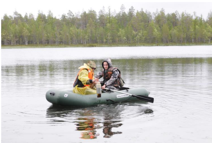
Рисунок 3.9 - Отбор проб воды на озере Голубое 3, при помощи пробоотборной системы СП-2 [фото автора]
