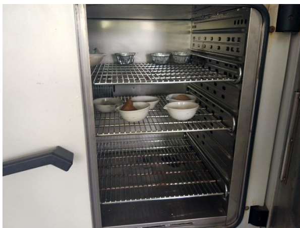
Рисунок 4.4 – Высушивание образцов в сушильном шкафу (Фото Куликовой Т.С.)
