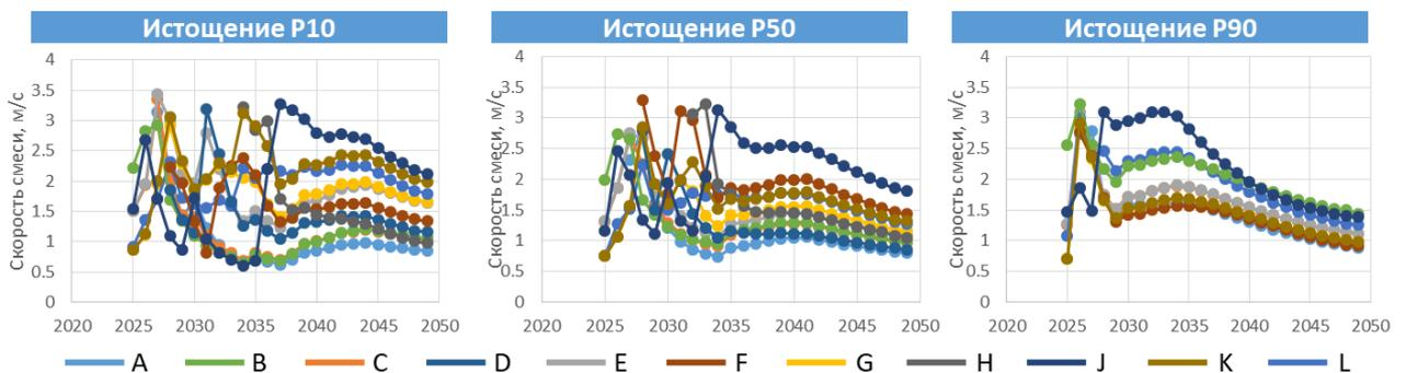
Рис. 8.10 Зависимость скорости газожидкостной смеси от времени для режима истощения
