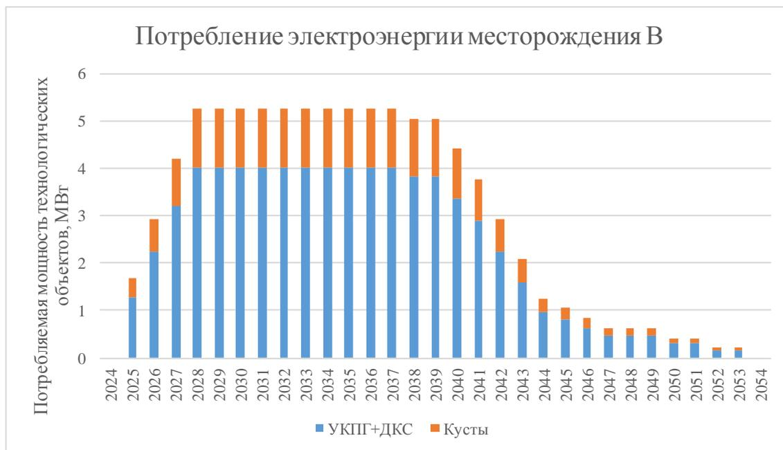
Рис.6.9.1 Потребление электроэнергии в ходе разработки месторождения «В»
