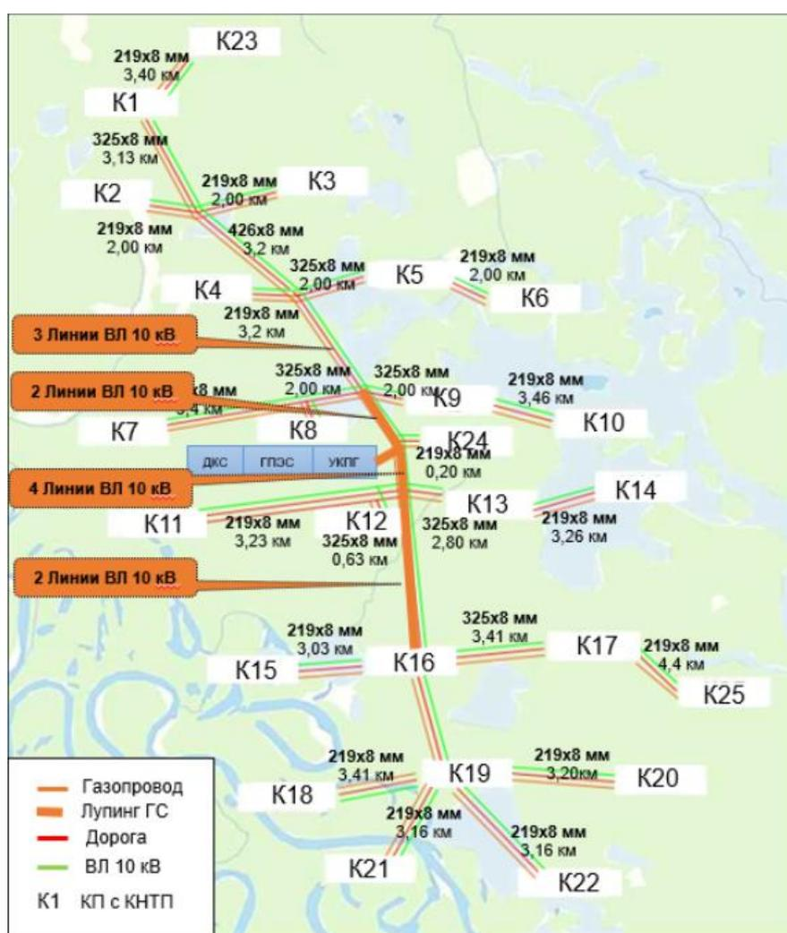
Рис.6.9.2 Электрическая сеть месторождения «В»
