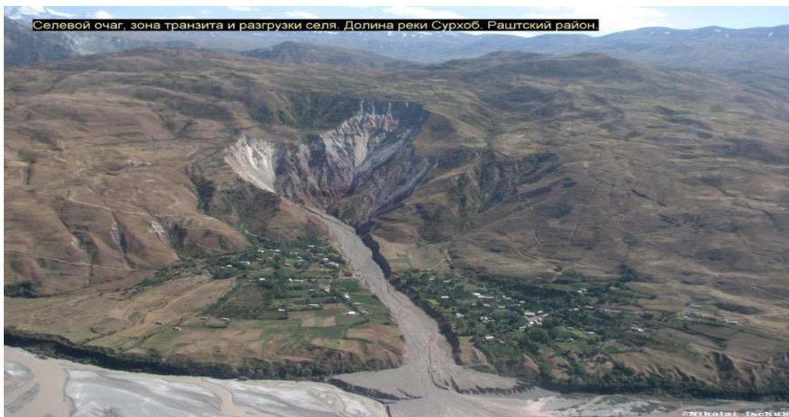
Рисунок 10. Классическая структура селя в селе Обчака в долине реки Сурхоб, показывающая зону зарождения, транзита и аккумуляции (фото Н. Ищука).
