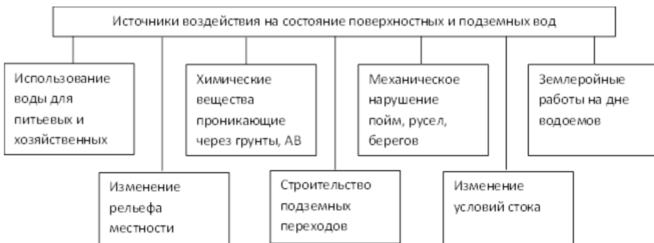
Рис. 1.2. Источники воздействия на состояние поверхностных и подземных вод при строительстве и ремонте трубопроводов (составлено автором)
