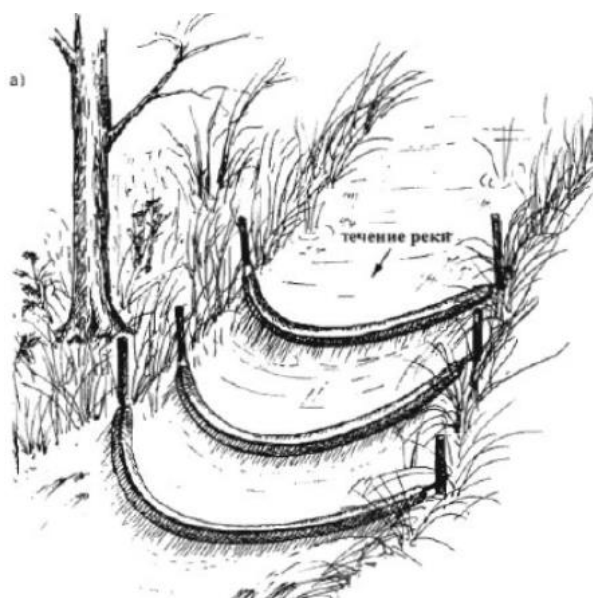
Рис. 11. Схема установки боновых заграждений
