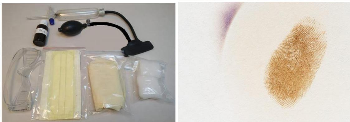
Рис. 7. Обработка следов парами йода
