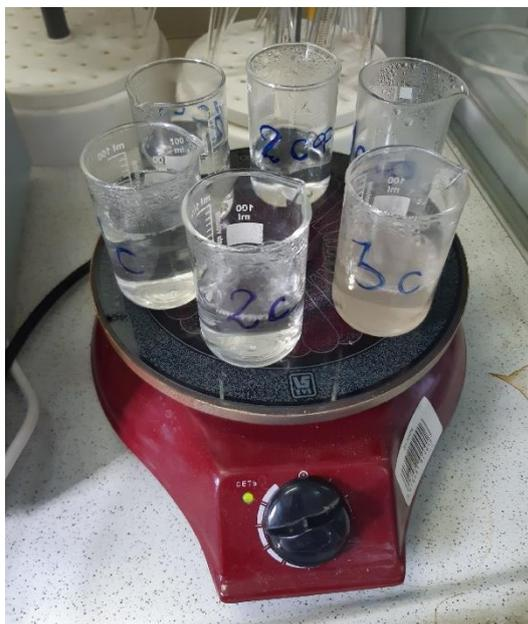
Рис. 13. Выпаривание воды для микроскопического анализа
