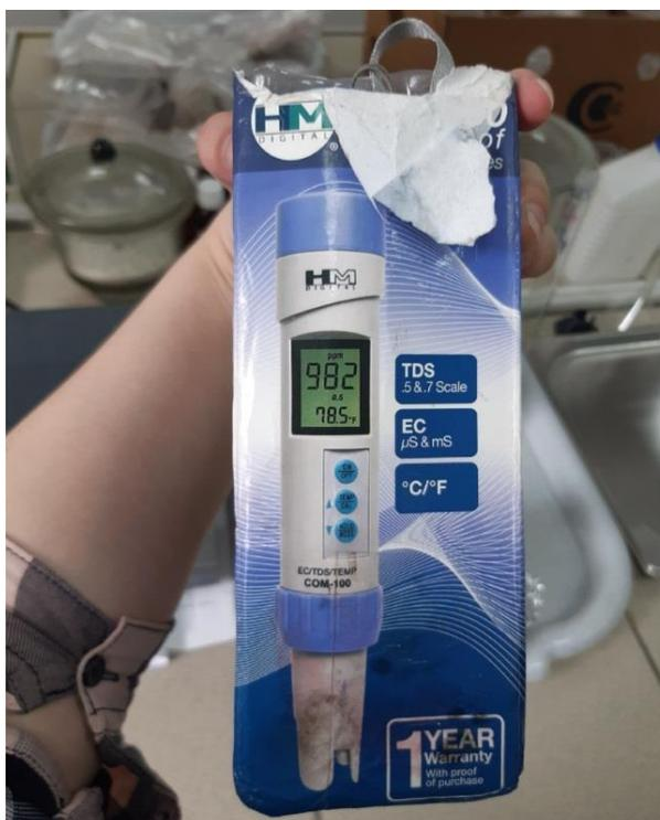
Рис. 9. COM 100 Прибор для измерения уровня общей минерализации (солесодержания), электропроводности и температуры воды (по данным авторов)
