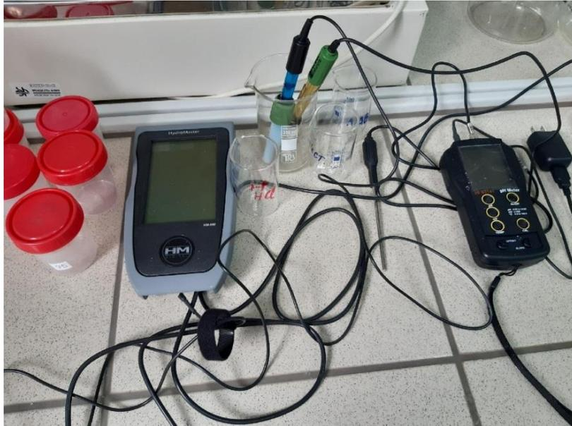
Рис. 6. Лабораторный иономер HI83141 и лабораторный иономер HydroMaster HM-500
