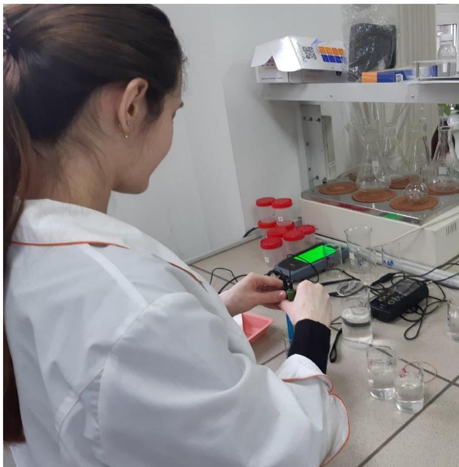
Рис. 8. Работа с лабораторным ионометром HI83141 и лабораторным ионометром HydroMaster HM-500 (по данным авторов)
