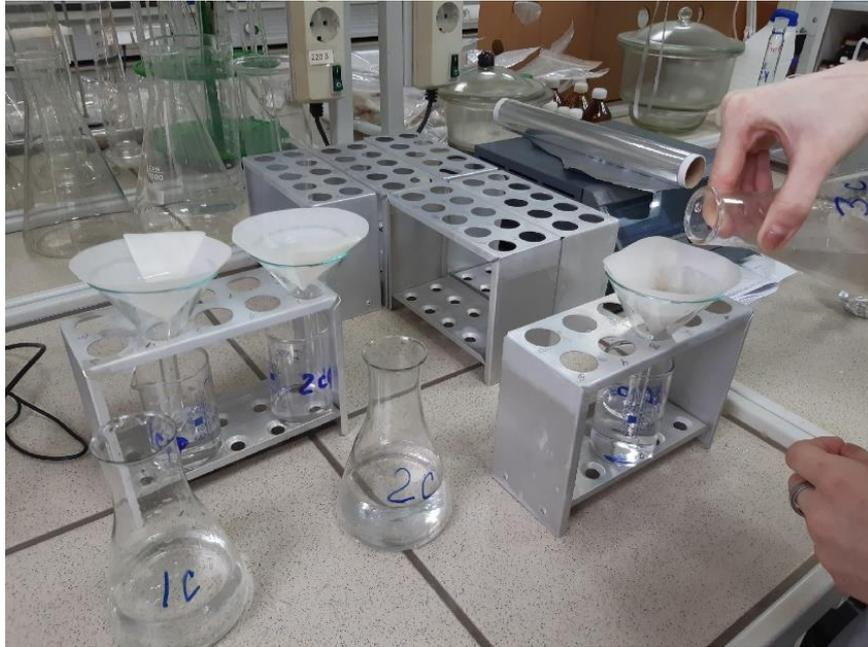
Рис.11. Фильтрация талой воды через беззольный бумажный фильтр
