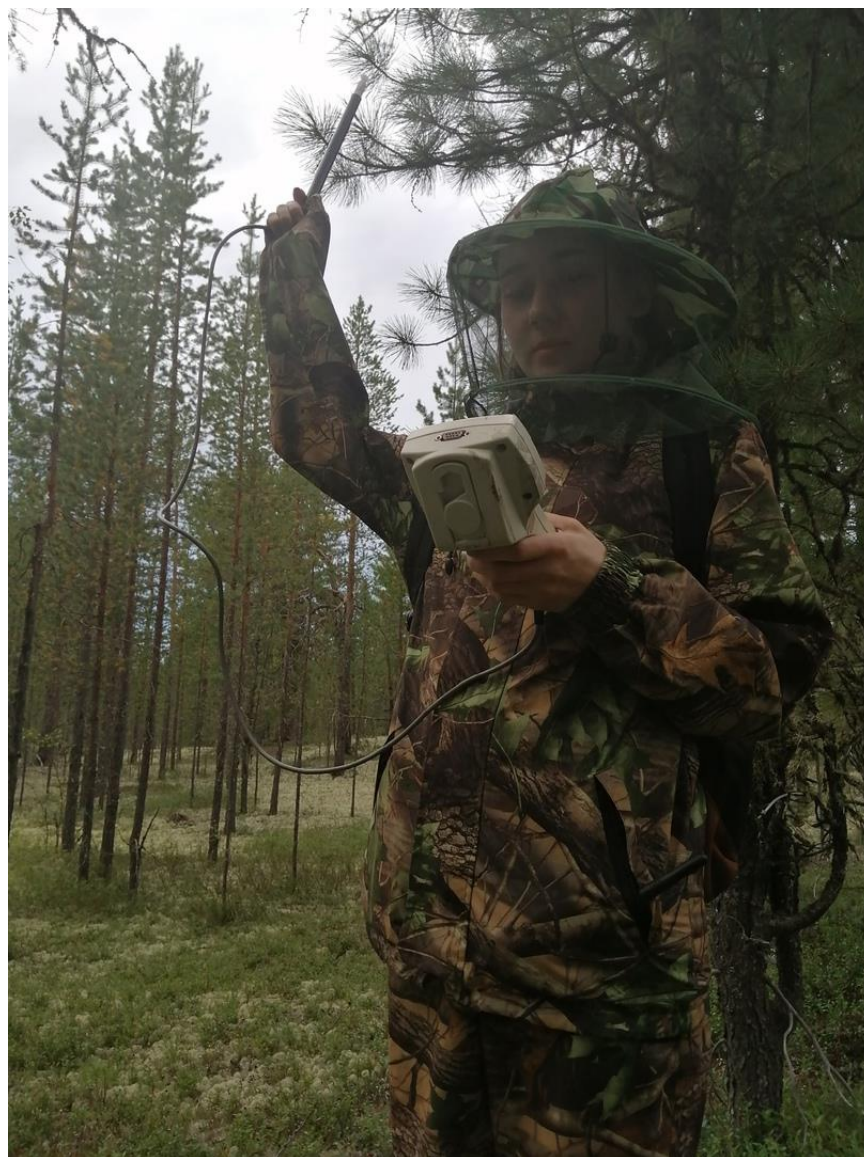
Рис. 4. Измерение параметров микроклимата прибором «МЕТЕОСКОП М» на территории лесного массива («лес») (фото автора)
