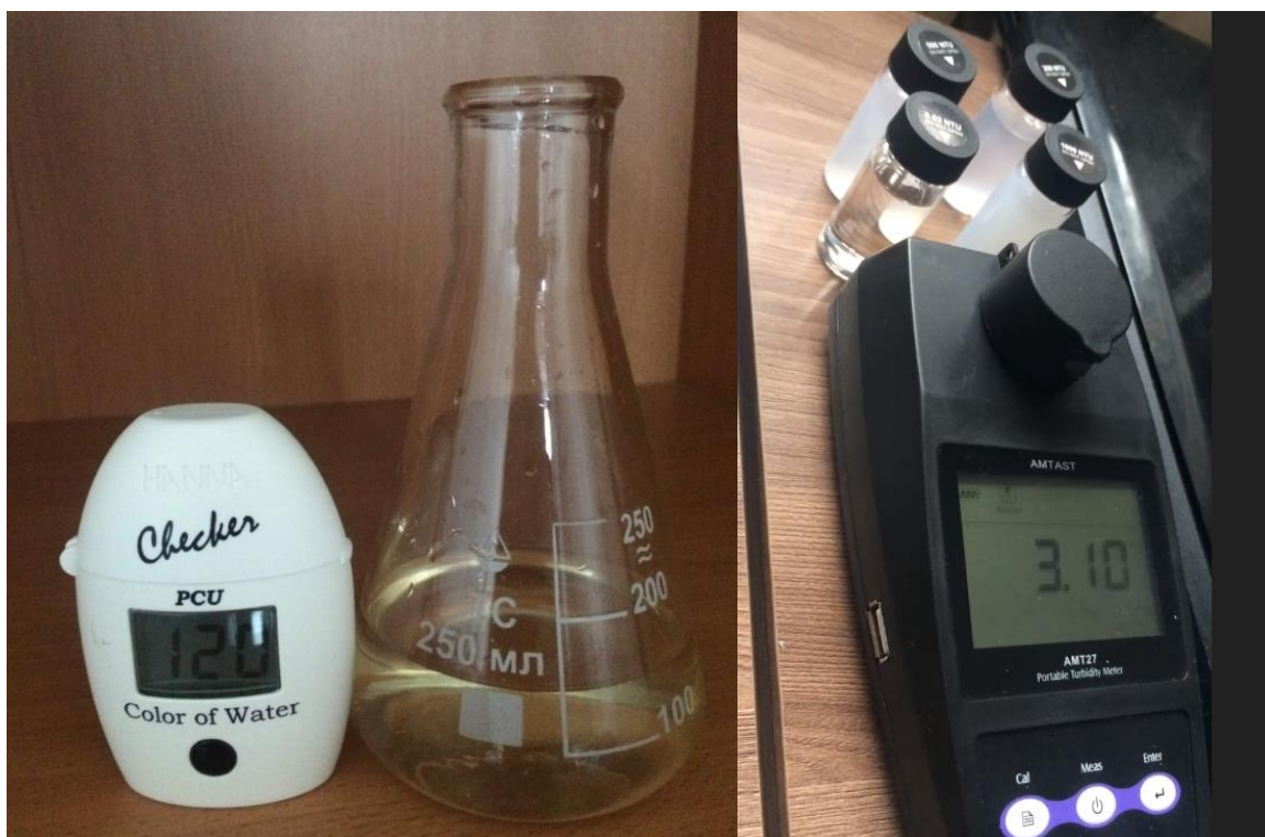
Рис. 10. Определение цветности и мутности воды приборами HI 727 HANNA и AMT 27 Amstat USA Inc [фото автора]
