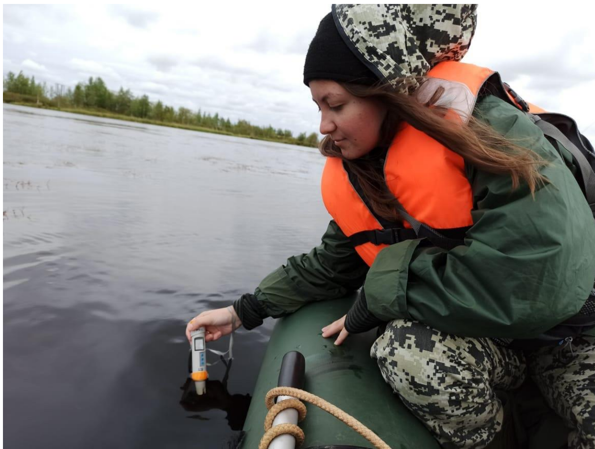
Рис. 9. Измерение водородного показателя, с помощью рН метра (РН-200) [фото автора]
