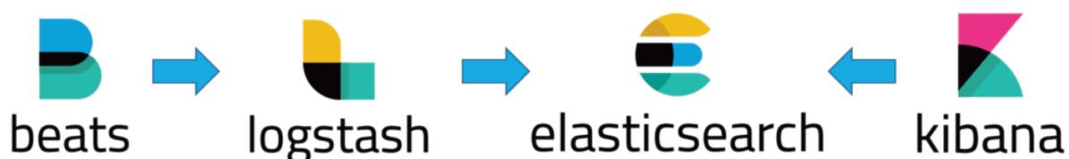
*Рис. 2.* Схема взаимодействия компонентов ELK Stack
