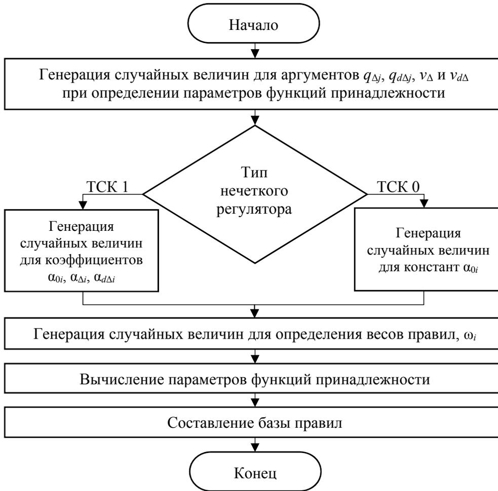
Рис. 2. Блок-схема процесса построения нечеткого регулятора на основе случайных величин
