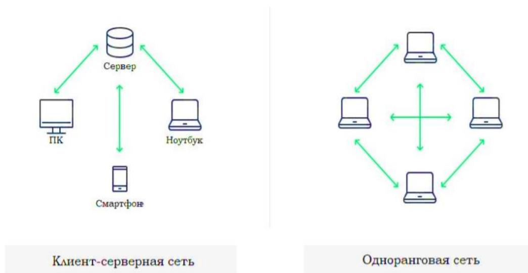
Рис. 4. Типы архитектур компьютерных сетей
