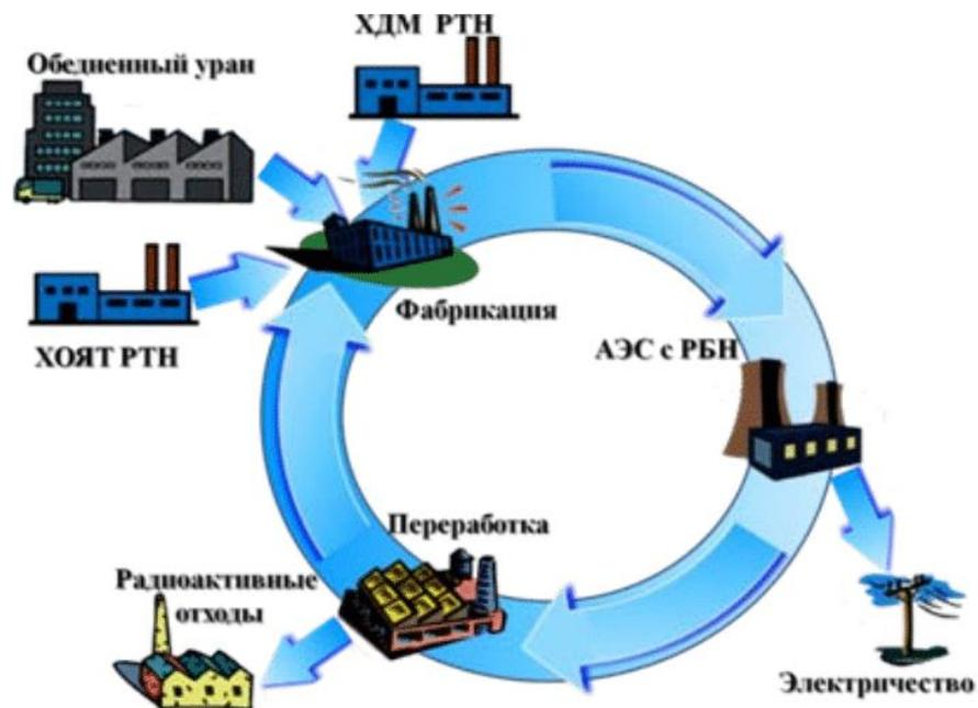
Рис. 3.2. Схема работы замкнутого ядерного топливного цикла
