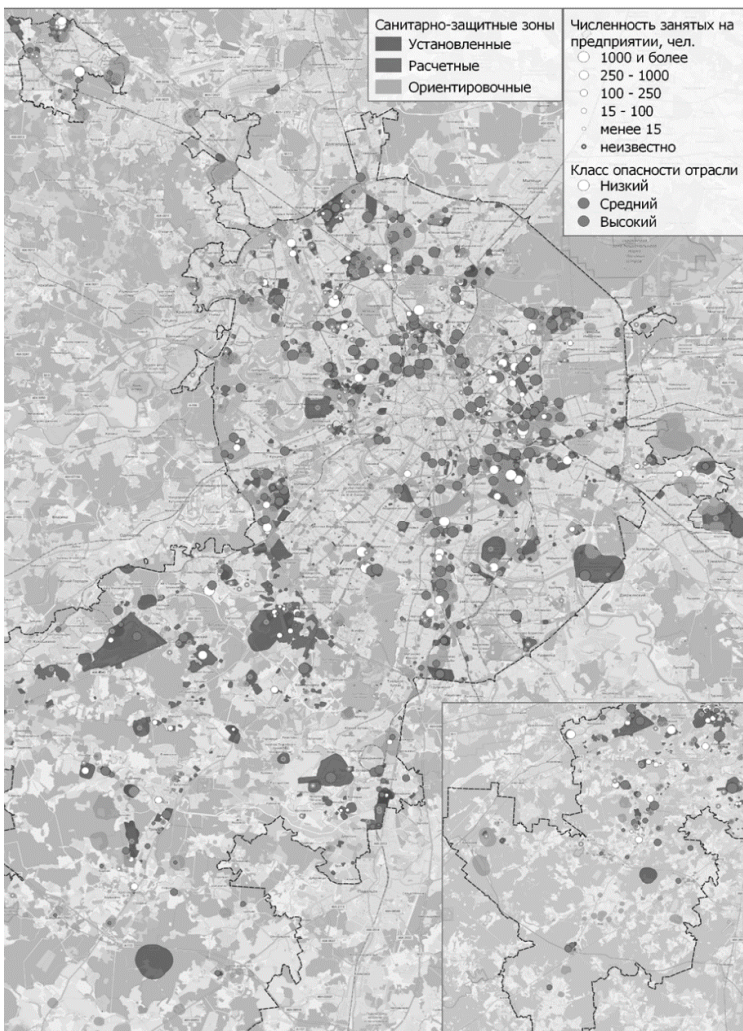
Рис. 1. Предприятия г. Москвы, имеющие вид деятельности, отнесенный к среднему и высокому классам техногенной опасности и санитарно-защитные зоны в Генплане г. Москвы
